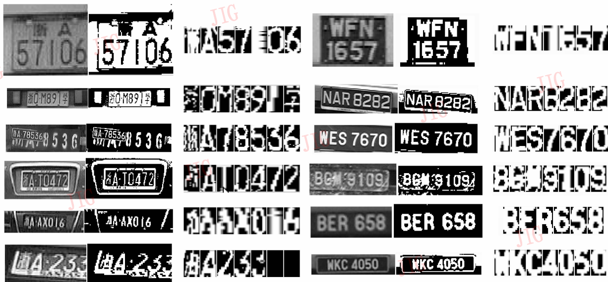
图 5 本文算法在国内车牌以及马来西亚车牌上的一些分割结果,其中包含了污损以及定位不准确的车牌
